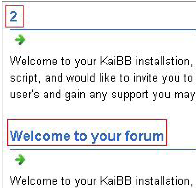
Abbildung 15. Ausgabe der Webseite nach eingefügtem „UNION+ALL+SELECT+1,2,3,4,5,6,7+“
